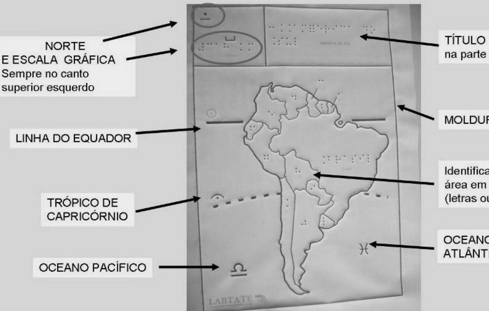
Figura 2 – *Layout* padrão dos mapas em escala pequena produzidos em papel microcapsulado Fonte: LabTATE (2008)
