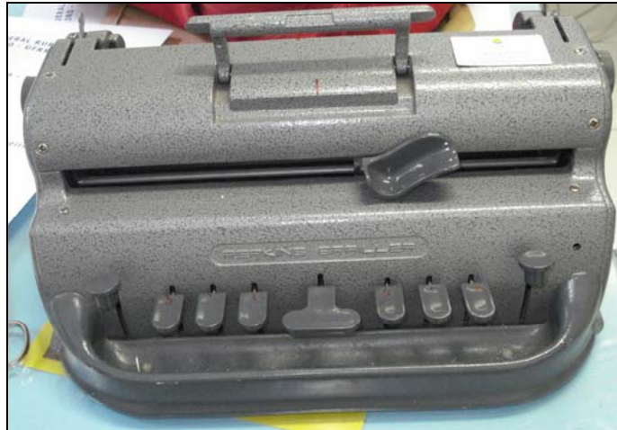
Figura 21 - Máquina Perkins Brailler
