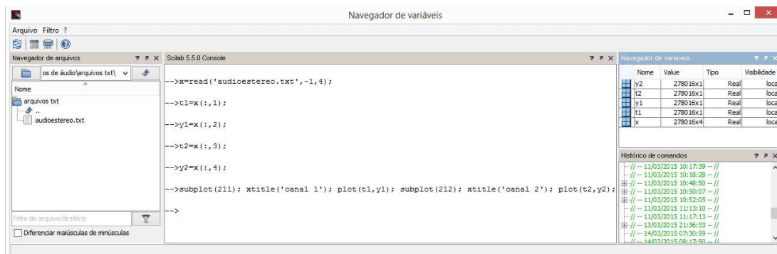
Figura 33: Importação de dados de um sinal de áudio no Scilab. Console Scilab, código para importação de áudio. Fonte: captura de tela do Scilab.
