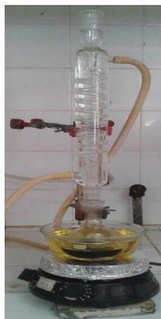
Para a funcionalização, 150,0 mg de MWCNT-OXI dispersos em 30,00 mL de tolueno e 24,28 mmol de VTMS com 1% de hidroquinona (m/m)
