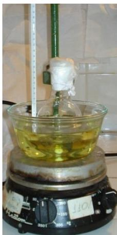
O nanocompósito obtido na síntese (MIP-MWCNT) foi lavado com uma mistura de metanol: ácido acético (4:1, v/v), para remoção da molécula molde e seco em estufa a 60 °C por 12 horas. O mesmo procedimento foi utilizado para a síntese do material sem a molécula molde (NIP-MWCNT), para o polímero impresso sem a presença dos MWCNT (MIP-Hemina sem MWCNT) e para o MIP sem hemina (MIP-MWCNT sem hemina). A Figura 14 apresenta o esquema representativo das etapas de síntese do nanocompósito.
