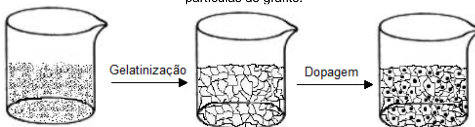
Figura 5: Esquema da transição sol-gel: formação de gel particulado e posterior dopagem com as partículas de grafite.
