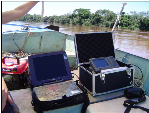
Figura 7 - Ecobatímetro FURUNO® com o sistema GPS acoplado a um computador portátil
