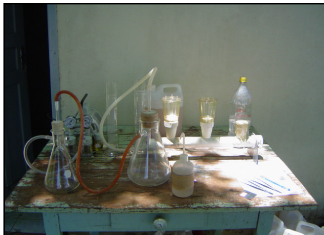
Figura 10 - Processo de filtragem da carga suspensa hidrotransportada
