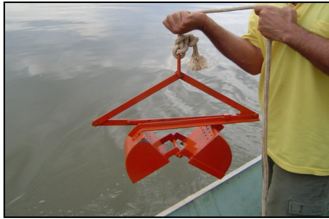
Figura 11 - Amostrador de fundo tipo van-veen
