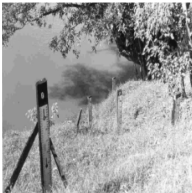
Foto 3 – Vista parcial dos lances de réguas – estação Porto Paraíso do Norte no rio Ivaí
