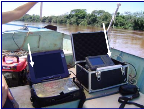
Figura 7- Noot Boock acoplado ao Ecobatímetro Furuno®. Fonte: foto do autor – 29/11/04.
