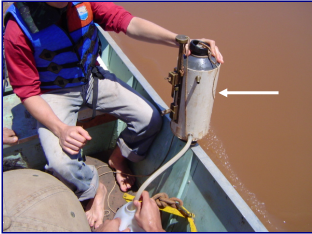
Figura 8 - Garrafa de Van Doorn , capacidade total de 5 litros. Fotografia tirada no momento de transferência da amostra de água da garrafa para o recipiente. Fonte: foto do autor – 29/11/04.
