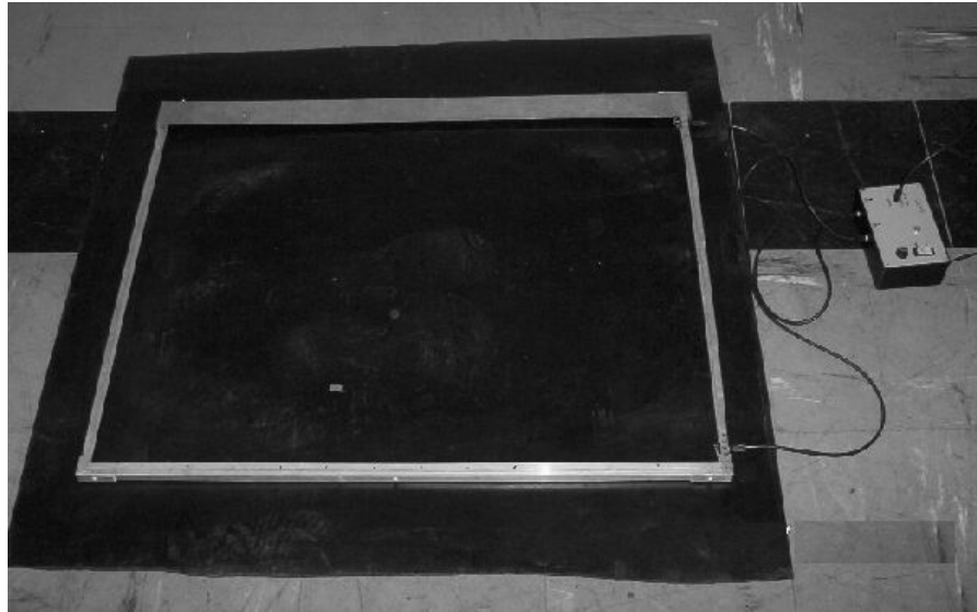
Figura 1. Plataforma de Salto Vertical PS-65 e seu sistema de aquisição acoplado a um microcomputador.
