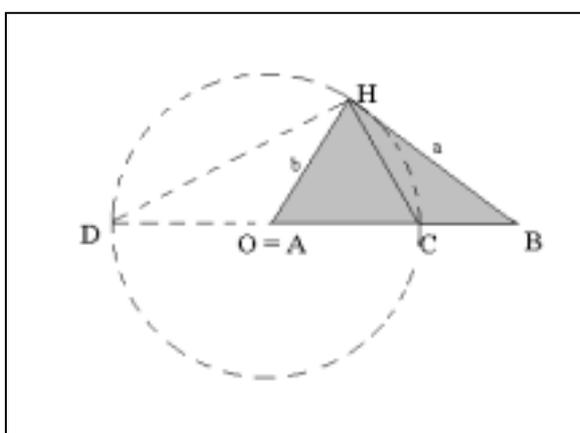
Seja o triângulo AHB retângulo em H;  $AB = h$ . Com centro em A, traça-se a circunferência de raio  $AH=b$ . Tem-se:  $\triangle BHC \sim \triangle BDH$  pois  $m(\widehat{BHC}) = \frac{1}{2}(\text{arcCH})$
