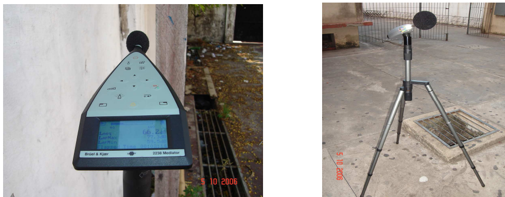
Fotografia 5.1 - Medidores de nível de pressão sonora
