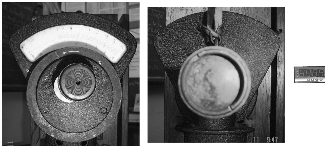
Figura 13 - Pirômetro óptico (1955) proveniente do Laboratório de Produção Mineral do Ministério da Agricultura (LPM) (à esquerda e ao centro). Faixa de temperatura: 700-2000 °C. Moderno pirômetro digital de radiação (à direita), observando-se a redução do tamanho de fornos, muflas, autoclaves e similares (faixa de temperatura 500-1800 °C).
