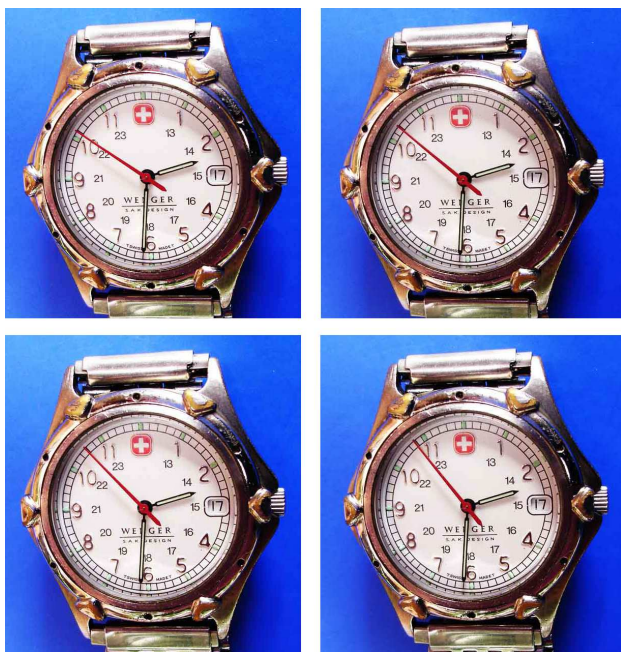
Figura 1 - Quatro fotos sucessivas de um relógio de pulso, com a câmara (Sony P150 ® ) regulada para o modo “burst”. Note que o ponteiro dos segundos avança de 1 s em cada foto. Este intervalo de tempo varia de câmara para câmara: note que este intervalo é diferente do das fotos do velocímetro, pois nestas foi usado outro modelo de câmara. A resolução das fotos foi ajustada para 1 M, e foi usada a função macro.
