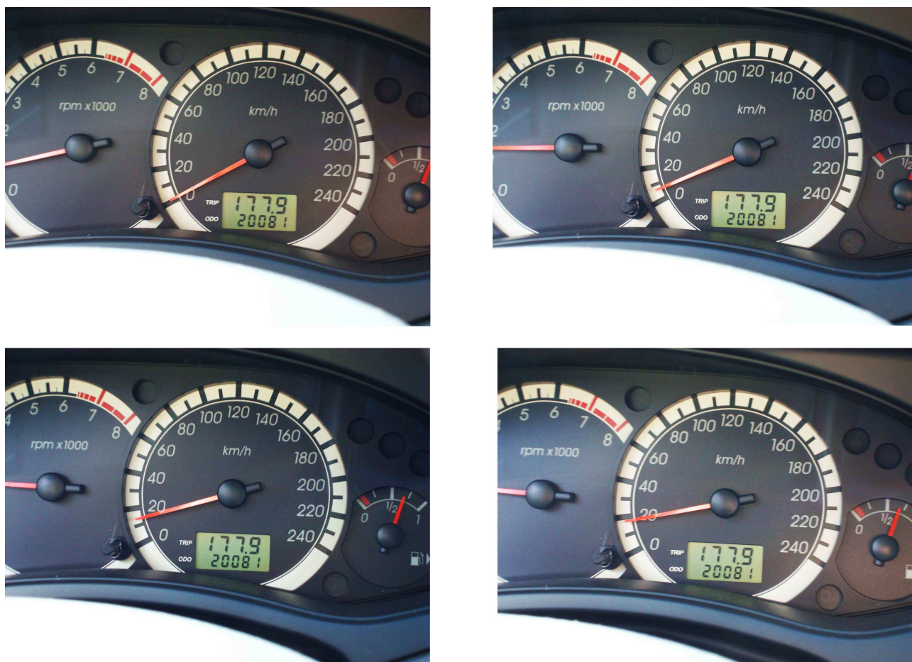
Figura 2 - Algumas das fotos sucessivas do velocímetro de um carro, desde o momento que ele parte do repouso (primeira foto) até atingir uma velocidade de 19 km/h. A primeira foto corresponde à primeira velocidade V_1 na Tabela 1, correspondente ao tempo t = 0 , a segunda (acima, à direita) a t = 1,5 s, a terceira (abaixo, à esquerda) a t = 3 s e a quarta, a t = 4,5 s.
