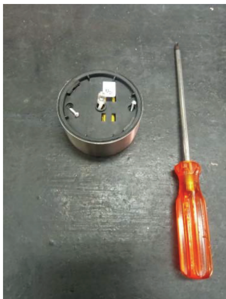
Figura 7: Retirada da tampa traseira da célula.
