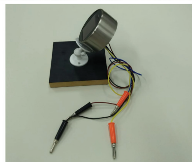
Figura 13: Célula conectada ao voltímetro e amperímetro e célula finalizada.
