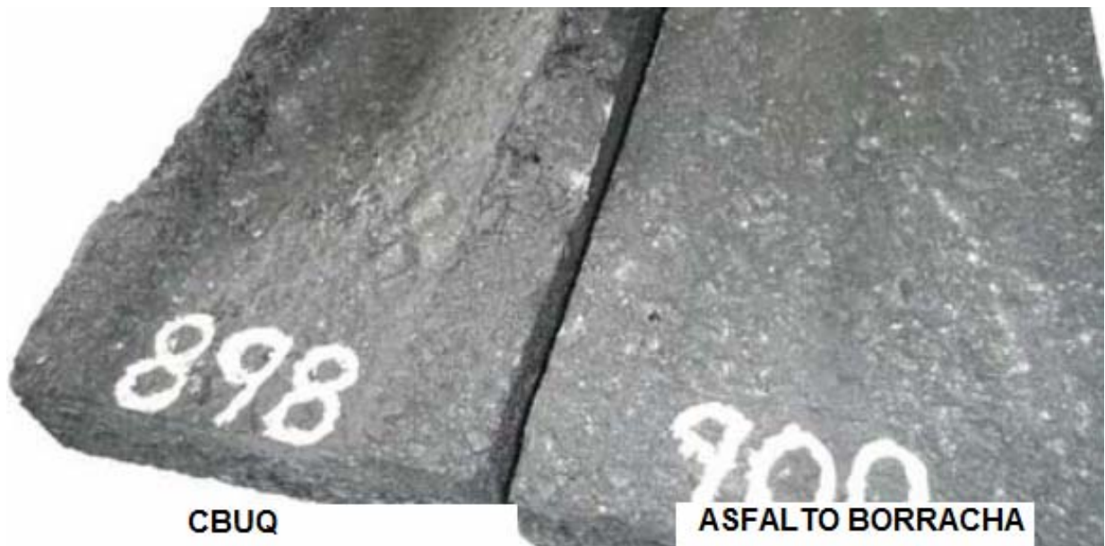
Foto 18: Placas de CBUQ e Asfalto Borracha após simulador de tráfego (Orniéreur)
