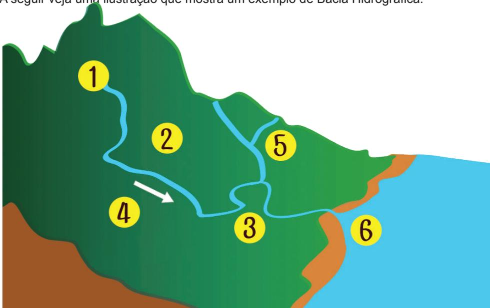
Desenho esquemático de uma Bacia Hidrográfica, sendo que os pontos marcados correspondem a: 1) nascente, 2) margem esquerda, 3) meandro, 4) margem direita, 5) afluente, 6) foz.
